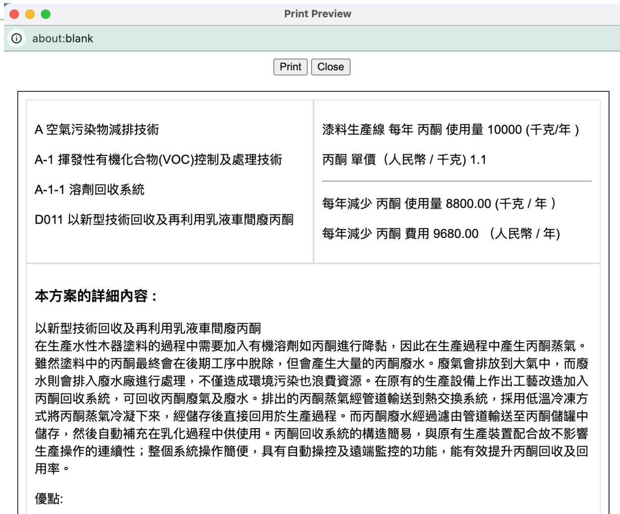
图 9：弹出窗口可预览选取技术相关耗物或耗能每年能减少使用量及费用的计算结果及该技术相关内容。
